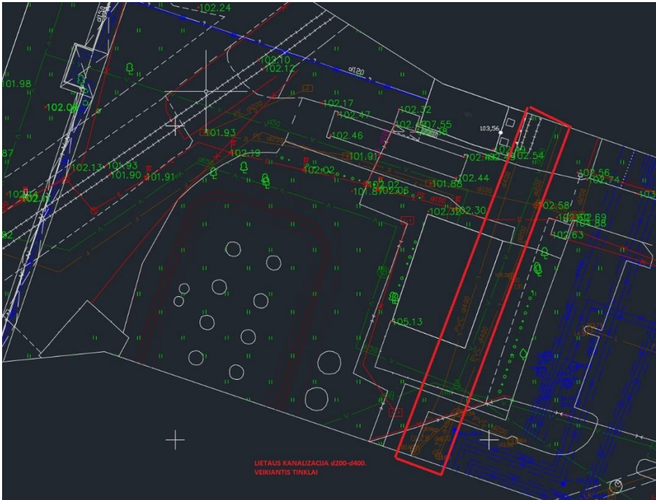
Paveikslas 14. Esami išsaugomi lietaus kanalizacijos vamzdiniai
